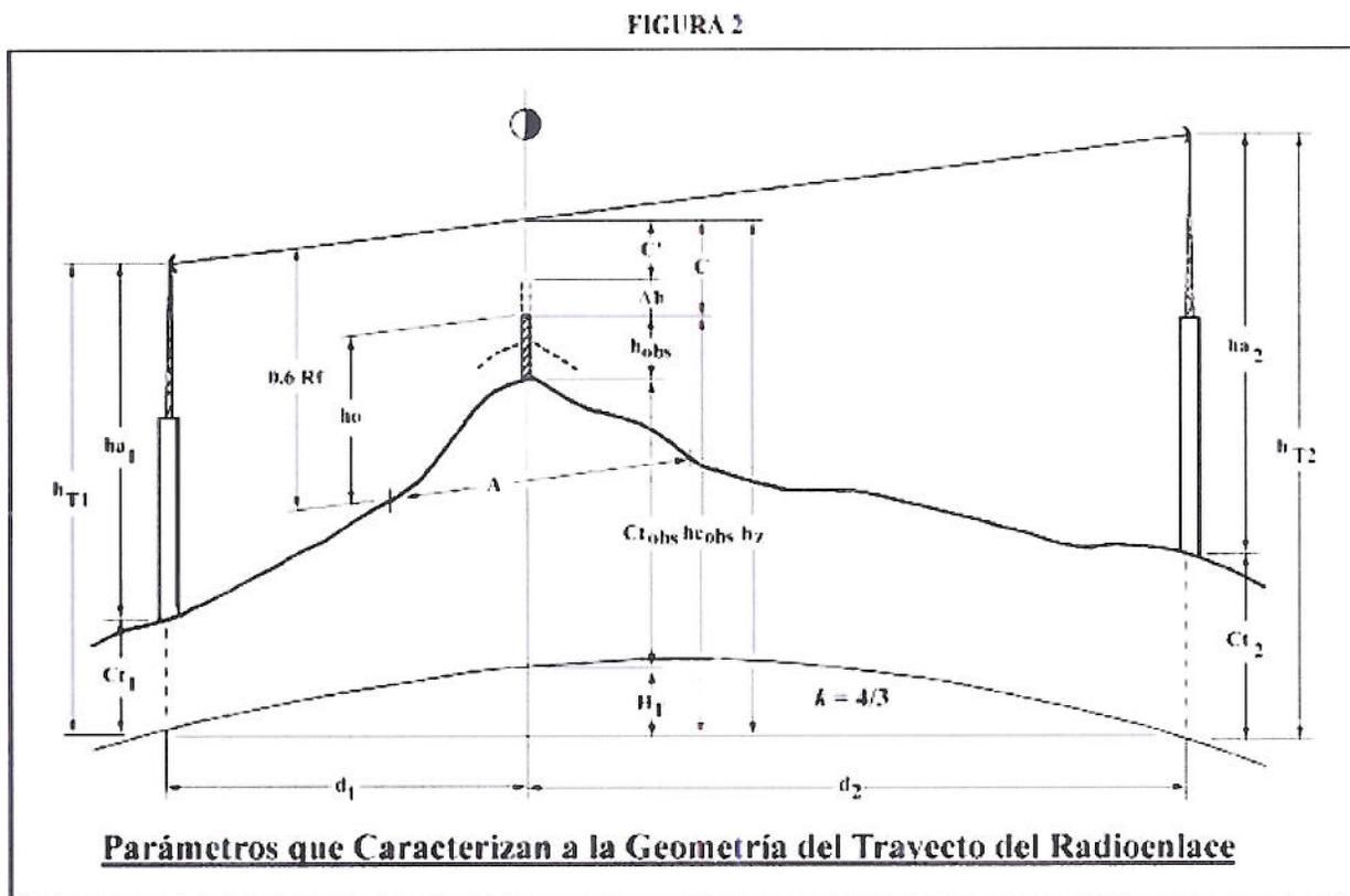
**Figura 3a Perfil del Terreno para  $k= 4/3$**
