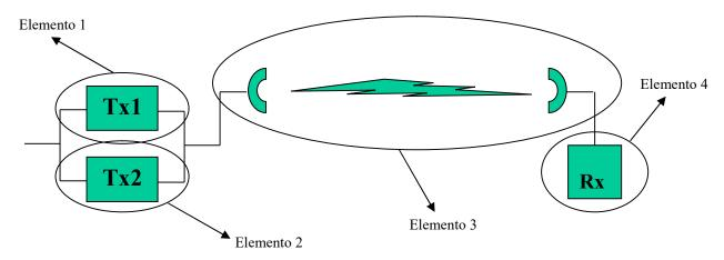
A continuación se muestra el diagrama funcional del sistema. Todos los elementos tienen una tasa media de falla = 0.05 fallas/año (MTTF=1 / 0.05 = 20 años), y tiempo medio de reparación MTTR = 20 horas
