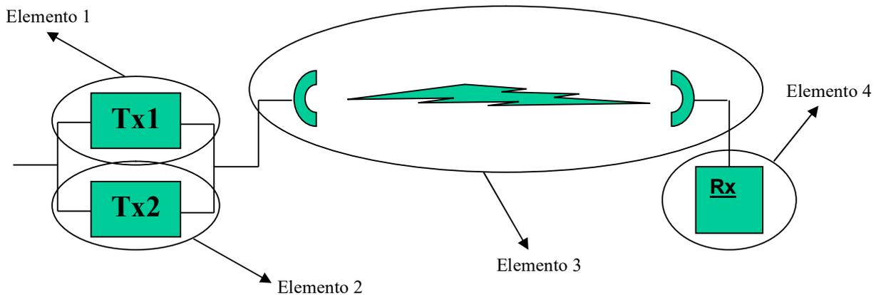
A continuación se muestra el diagrama funcional del sistema. Todos los elementos tienen una tasa media de falla  $\lambda = 0,05$  fallas/año ( $MTTF=1 / 0,05 = 20$  años), y tiempo medio de reparación  $MTTR = 20$  horas
