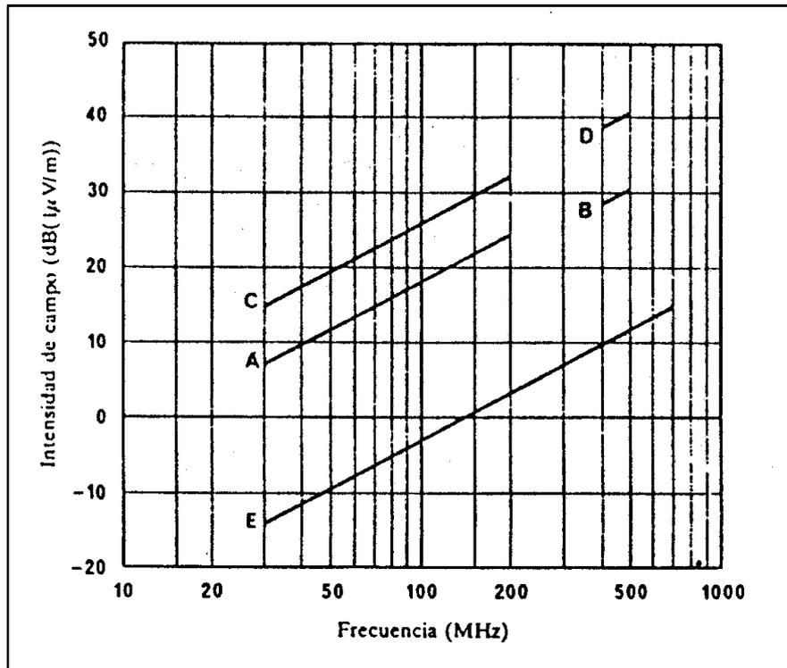
FIGURA 2 - Intensidad de campo mínima utilizable y mediana - Estaciones portátiles (Valores basados en una señal de entrada mínima utilizable con una f.e.m. de  $0,7 \mu V$  en ausencia de ruido artificial)
