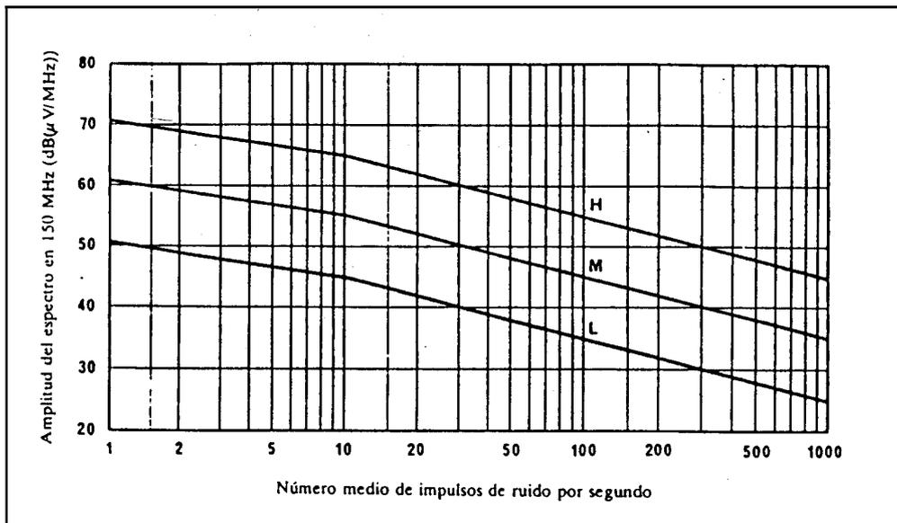
FIGURA 1 - *Distribución de amplitud del ruido en una estación de base (150 MHz)*
